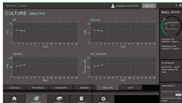
図5 インラインセンサーの測定値を経時的に示すモニタ画面
